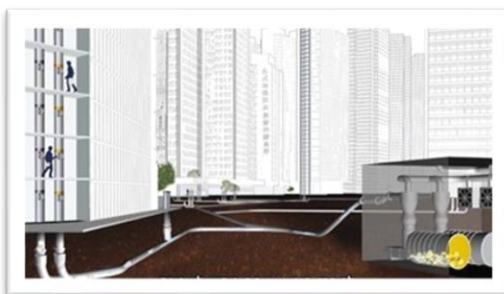
מערכת פינוי אשפה פניאומטית, "שיכון ובינוי". נמצאת בשימוש בעיריית יבנה. מתוך סרטון באתר שיכון ובינוי.
